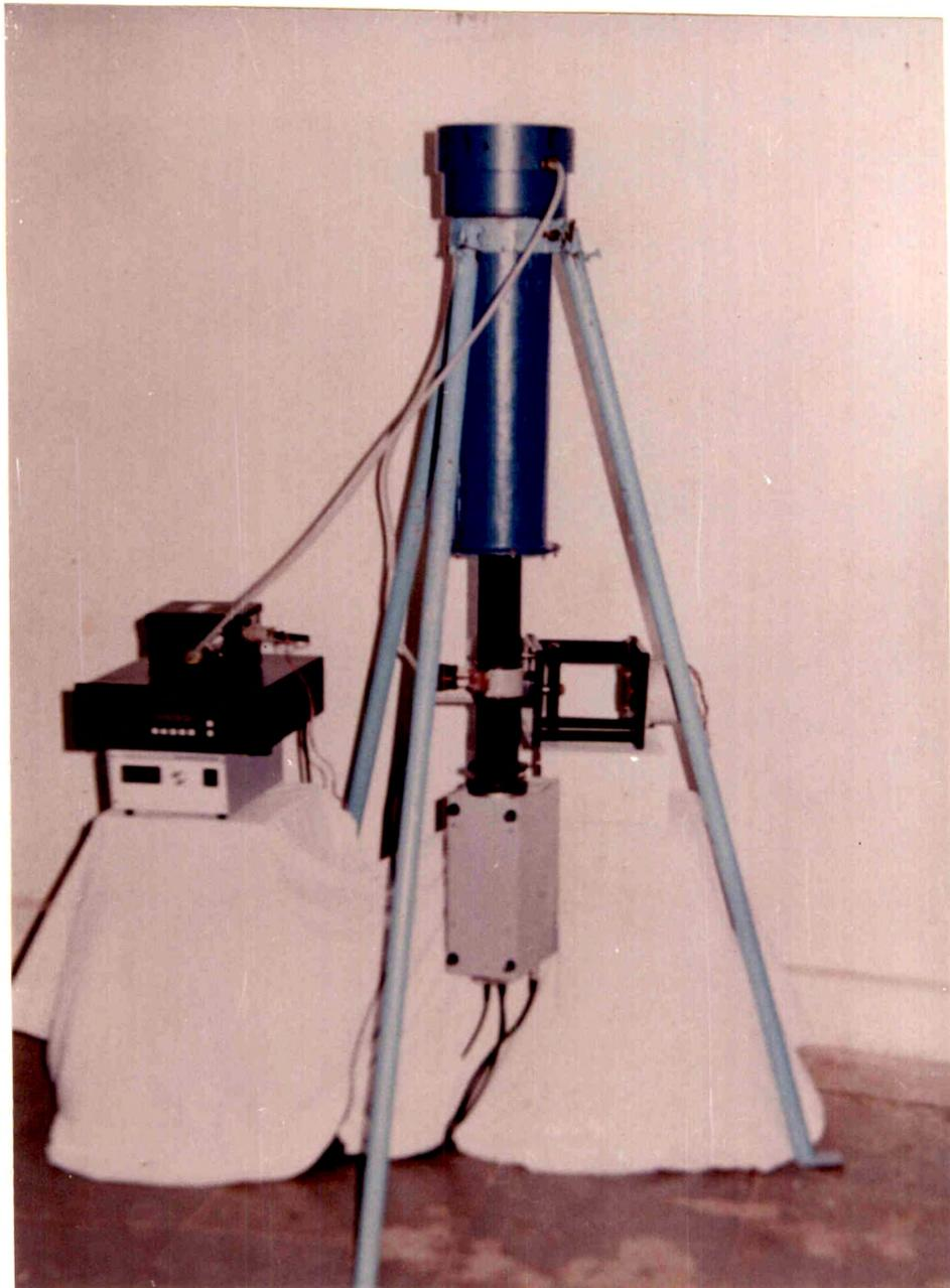
**Fig. 4.1. Fabry-Perot interferometer (FPI)**
